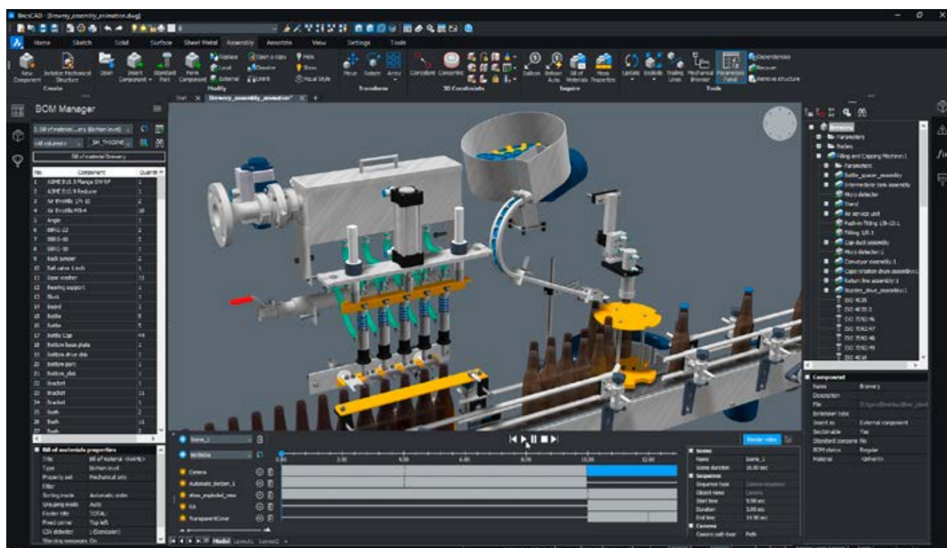
Rys. 4. BricsCAD Mechanical z wczytanym złożeniem mechanicznym w trakcie definiowania animacji ruchu. Po lewej stronie widoczny panel tworzenia tabeli zestawień BOM
